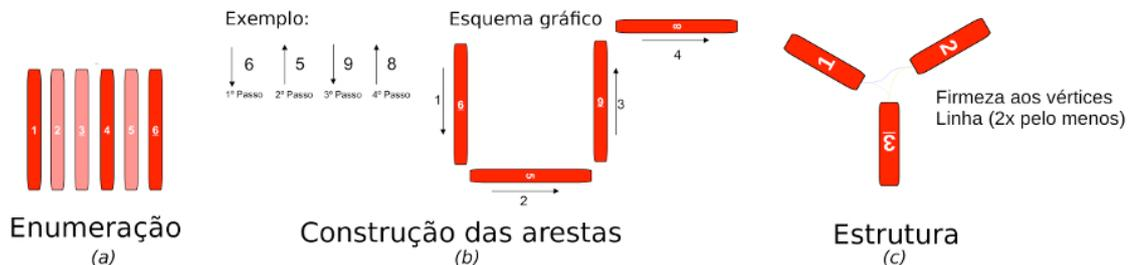
Figura 3 - Cuidados no processo de construção
