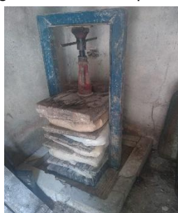
Figura 6- Prensa de parafuso
