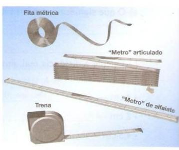
A imagem mostra quatro tipos de instrumentos de medição: uma fita métrica enrolada, um metro articulado (de madeira), um metro de alfatate (de metal) e uma trena (de metal).
