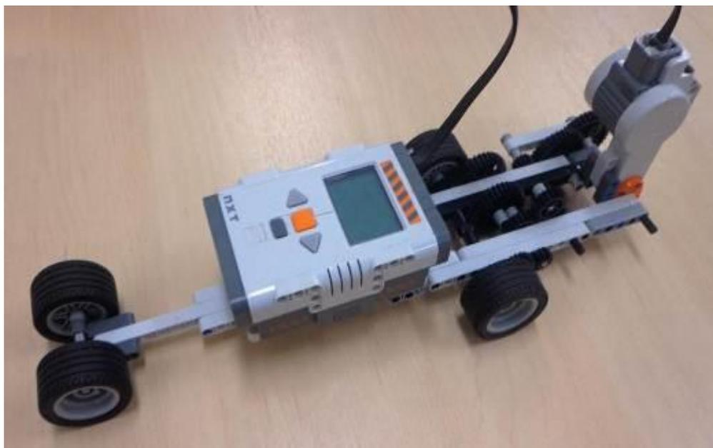
Figura 7 – Exemplo de protótipo de carro de corrida. Fonte: Elaborada pelo autor.
