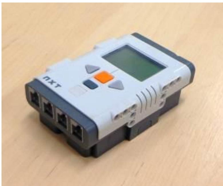
Figura 1 – Bloco lógico NXT Brick do Lego Mindstorms. Fonte: Elaborada pelo autor.
