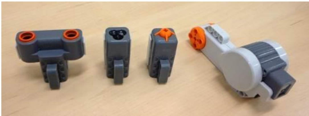
Figura 2 – Sensor ultrassônico, sensor de intensidade luminosa, sensor de toque e motor da plataforma Lego Mindstorms. Fonte: Elaborada pelo autor.
