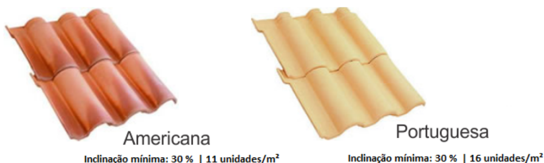
Figura 3 – Tipos de telhas de cerâmica
