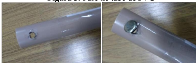
Figura 5: Furo no tubo de PVC
