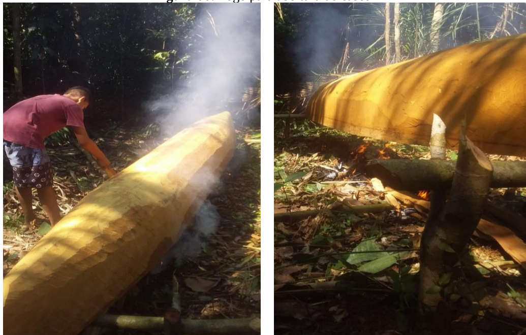
Figura 06: Fogo para abertura do casco
