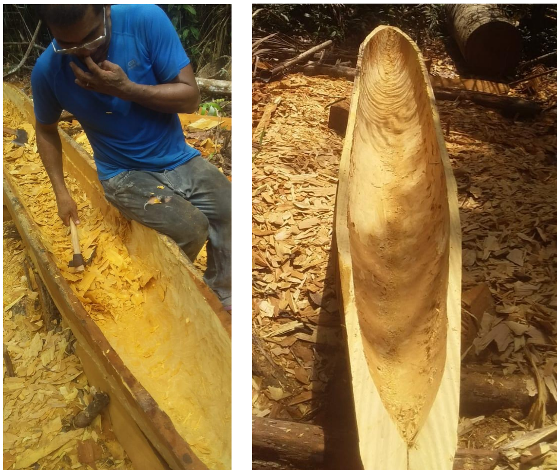
Figura 05: Limpeza para abertura do casco
