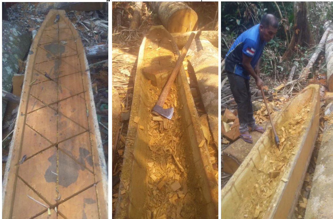
Figura 04: Momentos da escavação do casco
