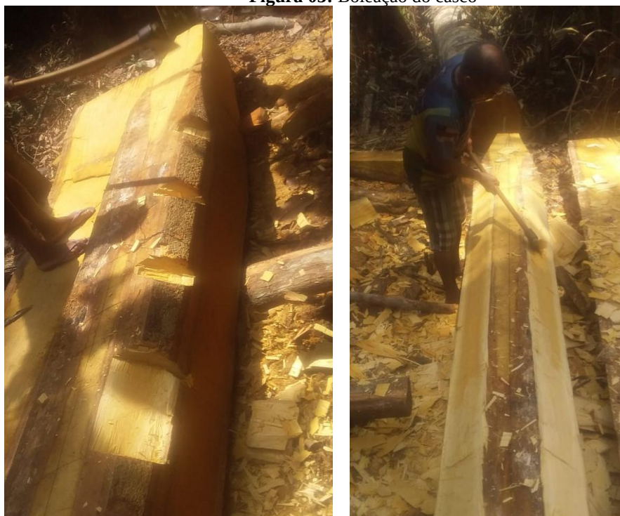
Figura 03: Boleação do casco
